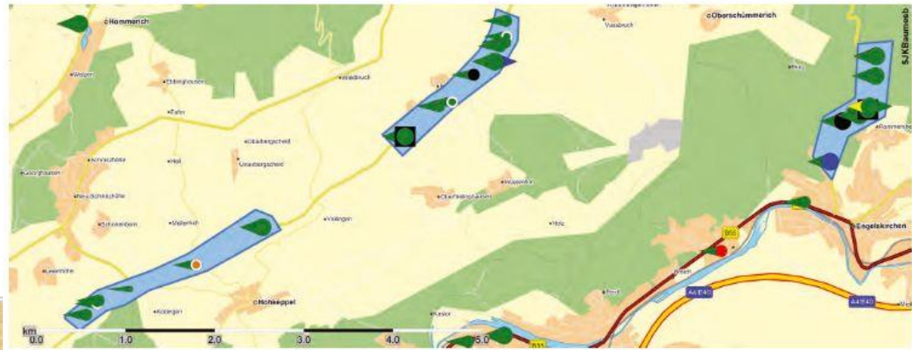
Bild 1: Auffällige Bereiche mit Unfällen mit Aufprall auf Bäume in einer Sonderkarte der Unfälle mit Aufprall auf Bäume aller polizeilich registrierten Unfälle für 5 Jahre
