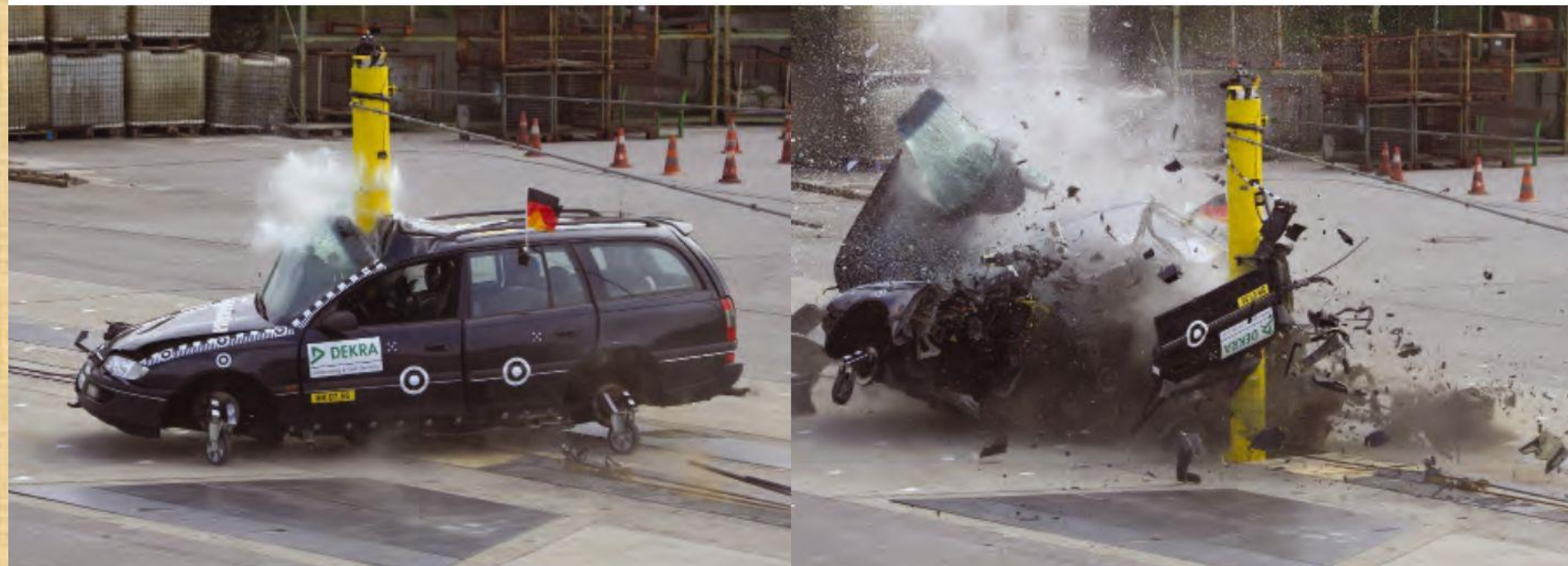
Bild 7: Pfahlanprall mit 97 km/h eines Opel Omega B Baujahr 1994 unter einem Winkel von 23° und einem Versuchsgewicht von 1.656 kg. [5]
